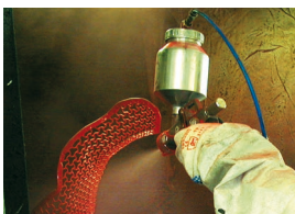
Klebstoffauftrag durch Spritzen Klebstoffauftrag durch Siebdruck
