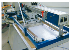
Klebstoffauftrag durch Spritzen Klebstoffauftrag durch Siebdruck
